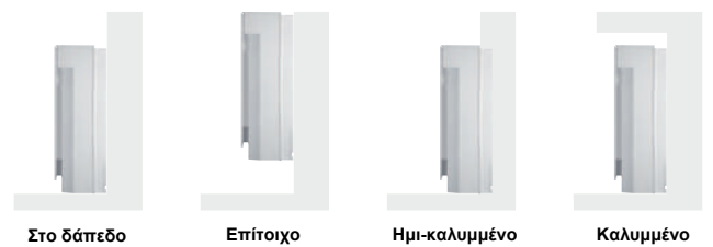
Στο δάπεδο Επίτοιχο Ημι-καλυμμένο Καλυμμένο
